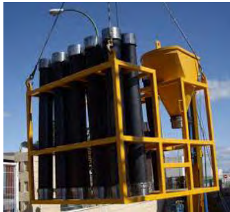
Figura 2. 54. Ejemplo de tubería tremie.
