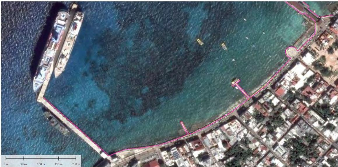
*Figura IV:13. Identificación de la línea de costa 2016 (amarillo) y 2019 (magenta) para evaluar el retroceso de costa.*
