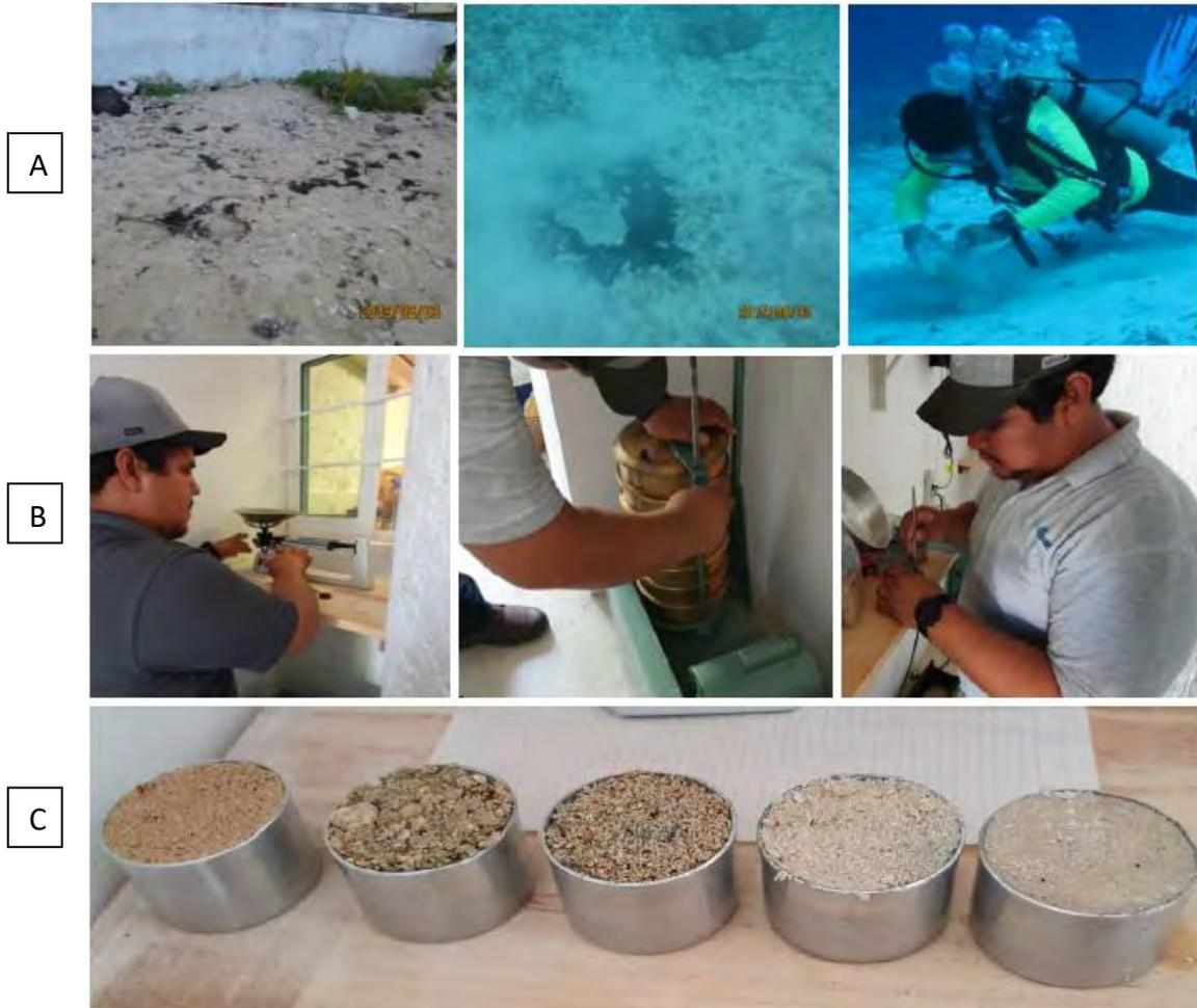
*Figura IV:25. (A) Recolección de muestras en playa seca, arena a 3m y 15m de profundidad, (B) Pruebas de laboratorio para granulometría, (C) Pruebas de densidad*
