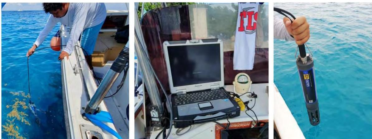
*Figura IV:27. Maniobra para la recolección de datos (izquierda), computadora de uso rudo (centro) y sonda multiparamétrica (derecha).*
