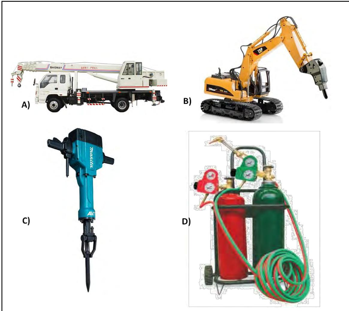
*Figura II:9. Equipamiento a emplear en las actividades demolición: A) Grúa de 5 ton, B) Retroexcavadora con martillo rompedor, C) Rompedores neumáticos, D) Equipo de corte oxiacetileno.*
