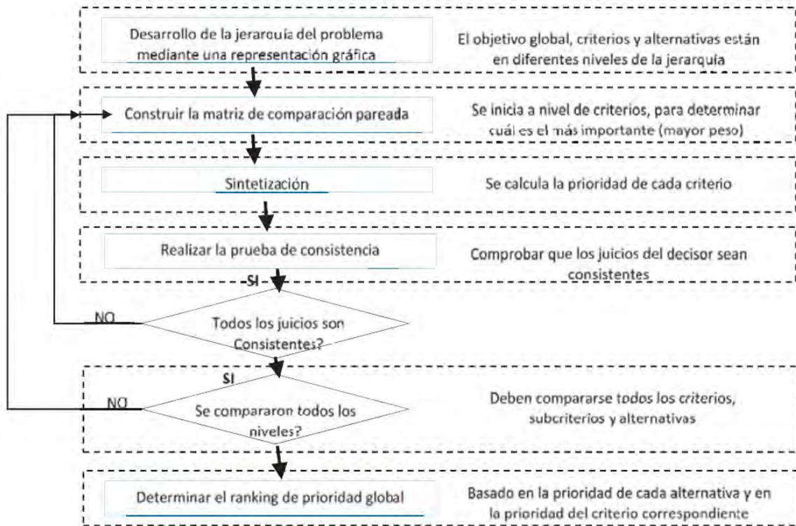
Figura V:1. Proceso de modelación de un problema multicriterio, software SuperDecisions.
