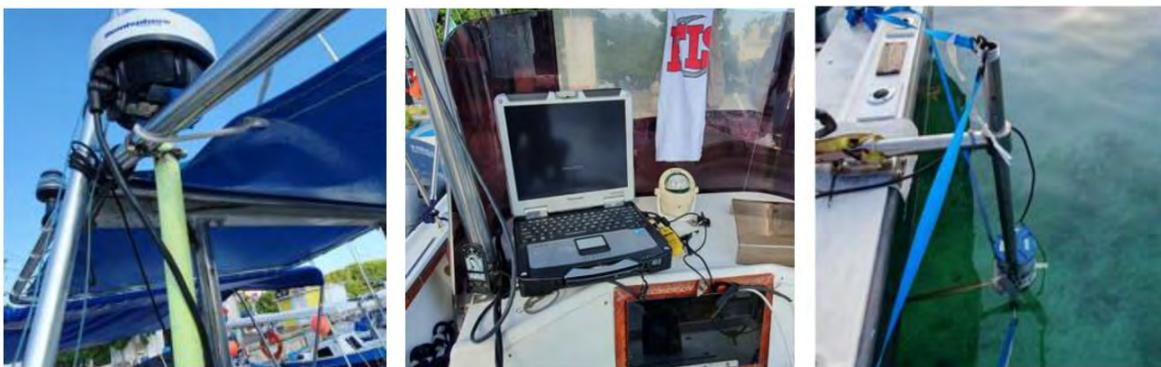
*Figura IV:19. Montaje de equipo para medición de corrientes en modo dinámico. Perfilador acústico Doppler (derecha), computadora de uso rudo (centro) y GPS (izquierda).*
