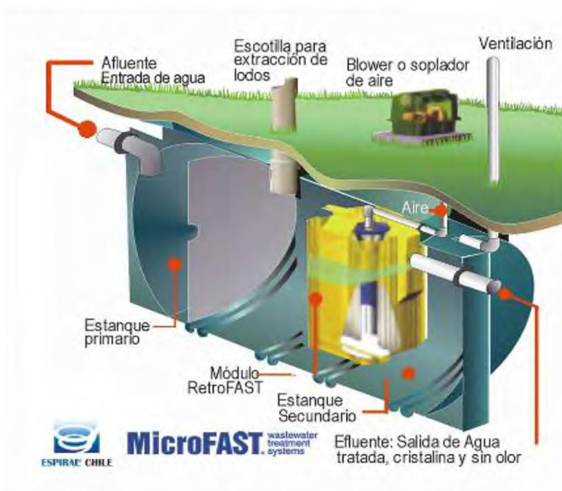
Figura 14. Esquema del diseño y acomodo de los componentes de la PTAR.
