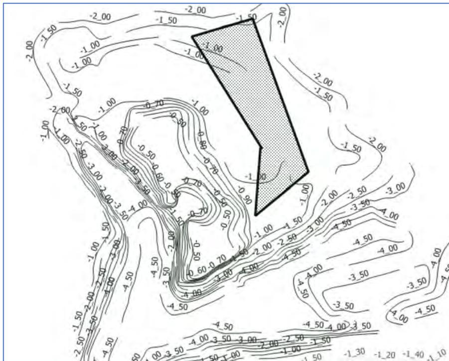
FIGURA 4.15 TOPOBATIMETRÍA DEL BANCO DE EXTRACCIÓN DE ARENA
