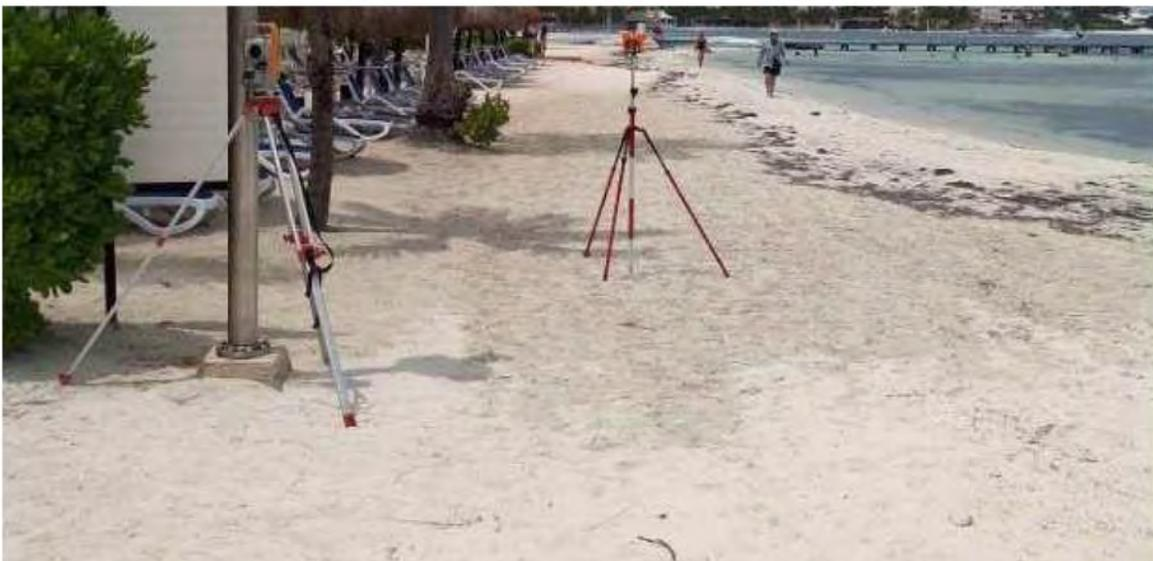
**FIGURA 4.12** EQUIPO EMPLEADO EN EL LEVANTAMIENTO TOPO/BATIMETRÍA (ESTACIÓN TOTAL Y PRISMA)
