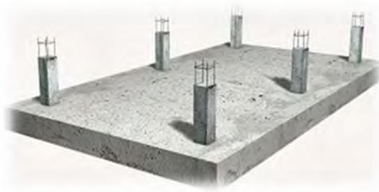
*Figura II:21. Figura representativa de una losa de cimentación*
