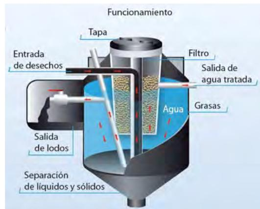
Figura II.4. Esquema generalizado del sistema de biodigestor.
