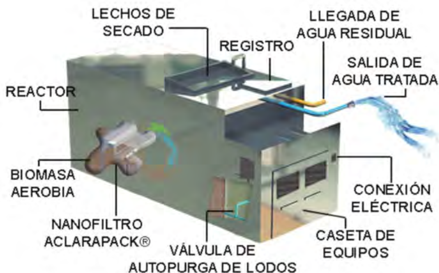
Figura 71.- Diagrama general de la PLANTA DE TRATAMIENTO ACLARAPACK.
