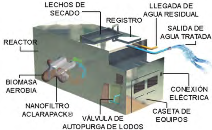
Figura 24.- Diagrama general de la PLANTA DE TRATAMIENTO ACLARAPACK.
