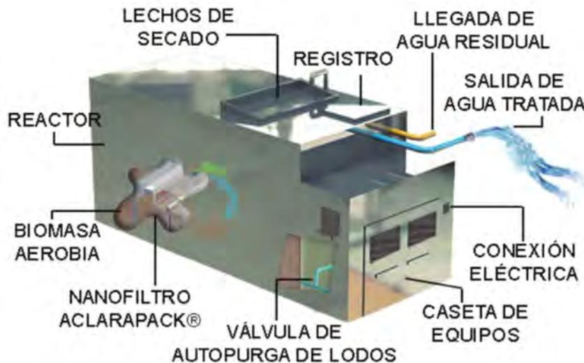
**Figura 23.- Diagrama general de la planta de tratamiento ACLARAPACK.**
