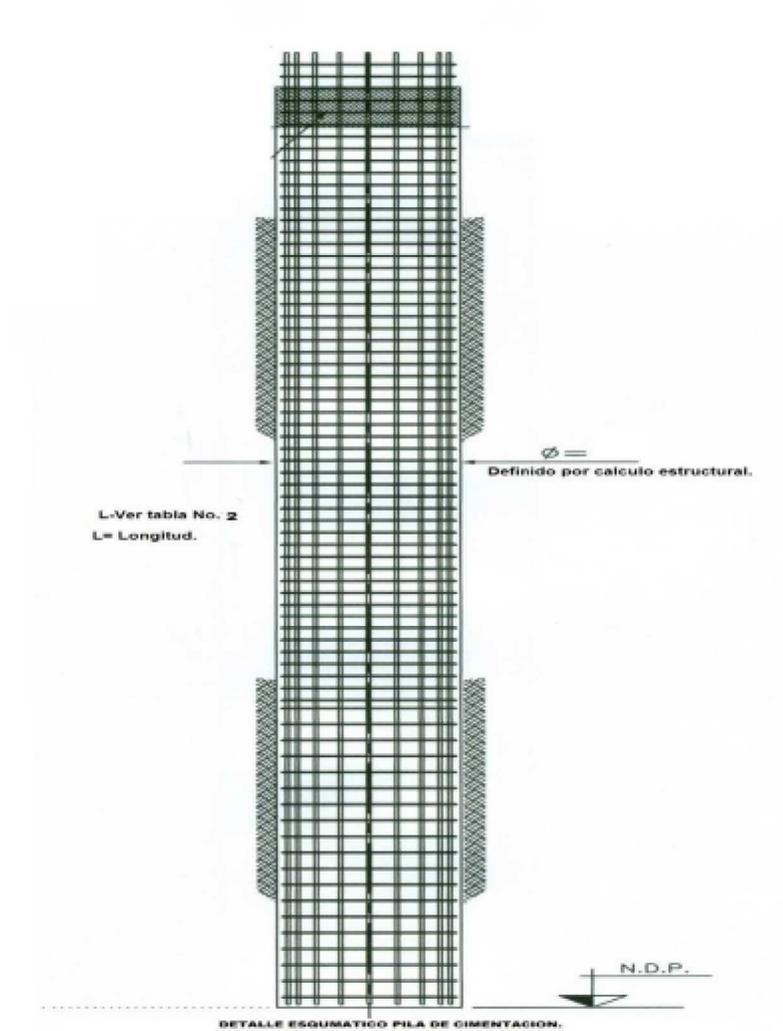
Para evitar la fuga de concreto en pilas, se deberá colocar ademe perdido en toda su longitud a base de lámina metálica calibre-18.
