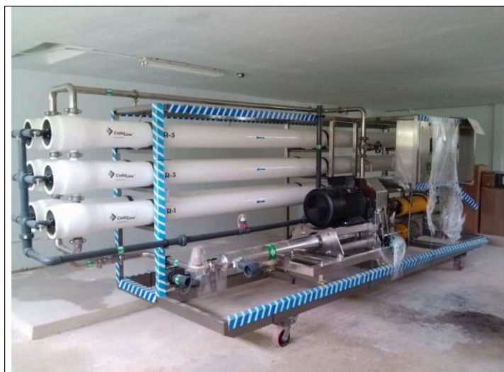
Figura 3. Ejemplo del modelo o prototipo de la planta de ósmosis inversa que se empleará en el hotel.
