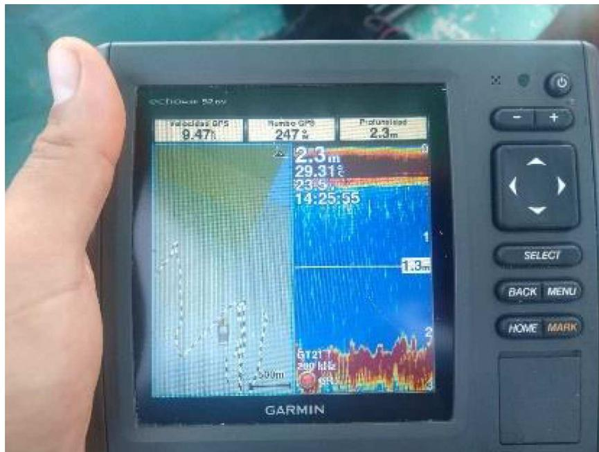
*Figura 22. Captura realizada durante el levantamiento batimétrico de la zona de estudio. En la mitad izquierda de la pantalla se aprecia el recorrido que se realizó dentro del polígono de estudio.*
