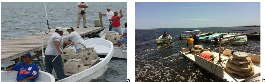
*Figura 11. Modos de transporte marítimo. a) embarcación acondicionada con una tabla de cimbraplay y b) lanchón equipado con brazo mecánico remolcado con lancha con motor fuera de borda.*
