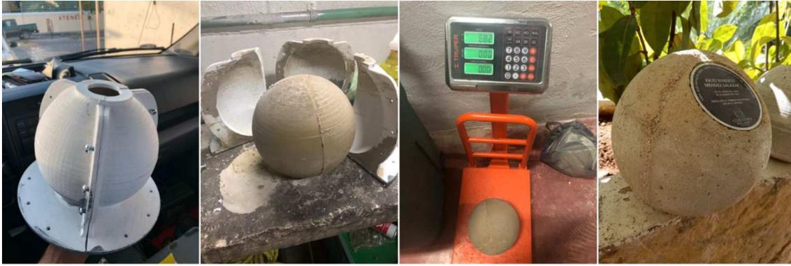
*Figura 9. Proceso de elaboración de la perla dentro de un arrecife de resguardo. De izquierda a derecha: Molde, perla recién desmoldada, peso de la perla y perla finalizada.*
