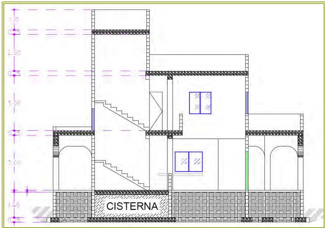
Corte de la vivienda, la altura máxima que se alcanza es de 9.85 ml hasta la protección al tinaco; en azotea se colocará un tinaco de 1,100 litros, un calentador solar y paneles. La vivienda se desplanta a 2.50 metros por encima del suelo natural, quedando únicamente la cisterna semi enterrada. Bajo la vivienda se localiza una cisterna de 1.25 ml de altura, con un volumen de 45.00 m<sup>3</sup> sobre un área de 36.00 m<sup>2</sup>.
