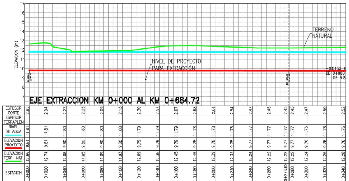
FIGURA 6 - CORTE TRANSVERSAL, DE LA ESTACIÓN 0+340.000 A LA ESTACIÓN 0+684.720
