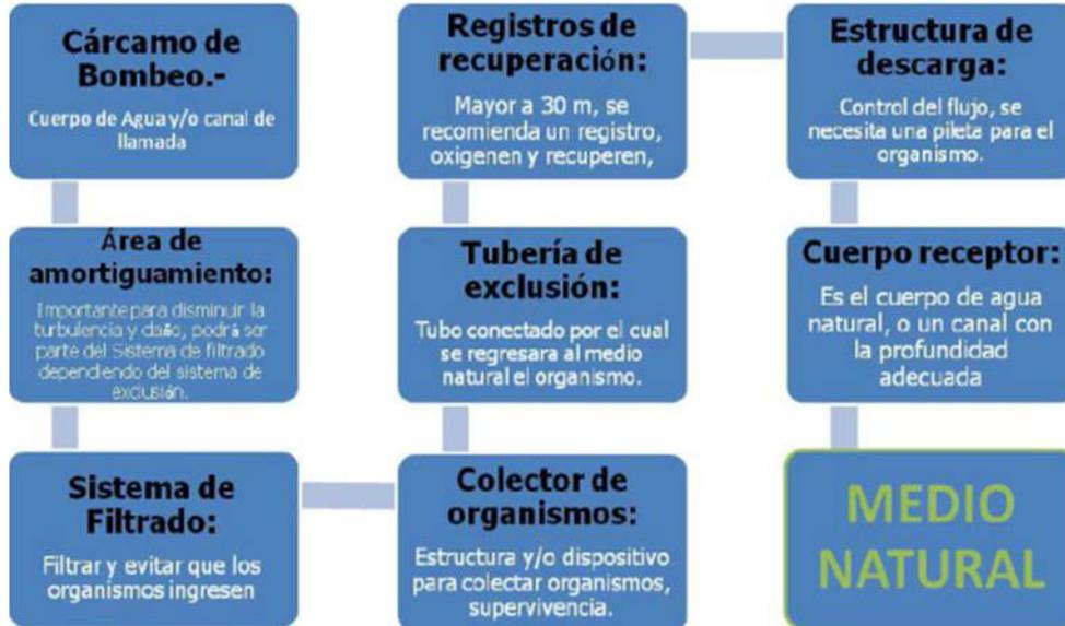
El sistema está comprendido por un área de amortiguamiento, dispositivo de filtrado, colector de organismos, tubos de exclusión registros de recuperación, estructura de descarga y cuerpo receptor.
