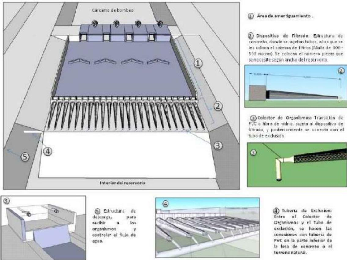
Figura 3- Esquema General del SEFA-3 que consiste en la adaptación del área de amortiguamiento en una pisa, plataforma o reservorio
