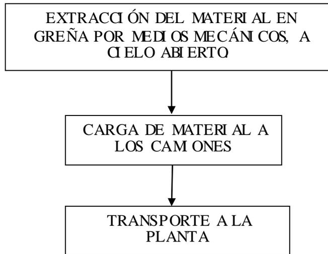
**EXTRACCIÓN:** La extracción del material en greña se realizará a través de dos Excavadoras CAT 325 L, con capacidad de cucharón de 1.19 m<sup>3</sup>.
