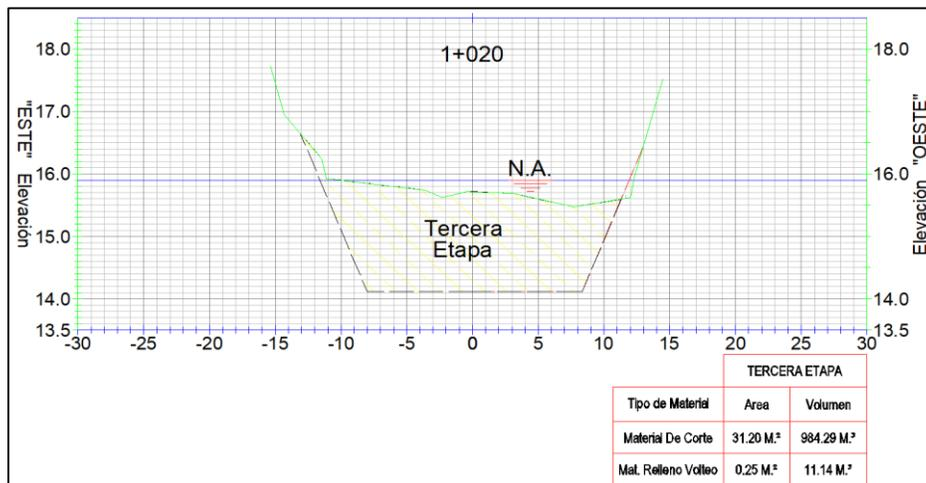
Imagen 7.- Sección típica.
