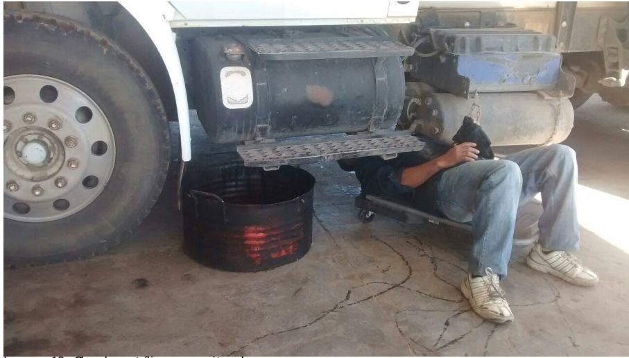
Imagen 19. Charca metálica para evitar derrames.
