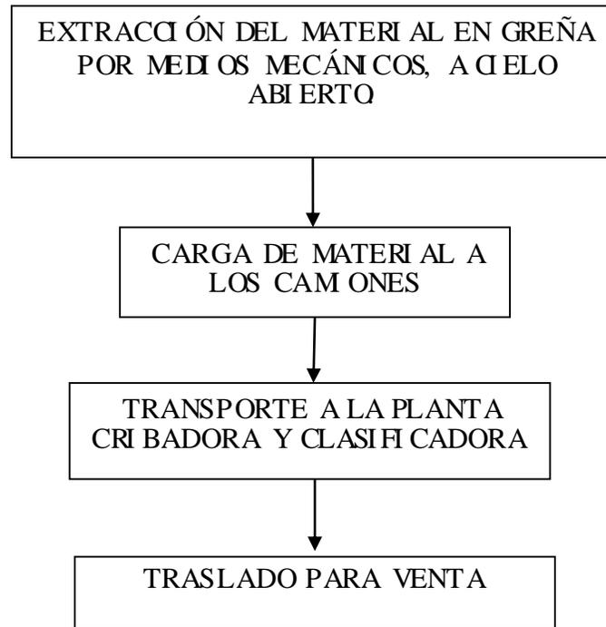
**EXTRACCIÓN:** La extracción del material en greña se realizará a través de una Excavadoras CAT 350L, con capacidad de 1.0 m<sup>3</sup>.
