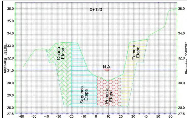
La línea verde representa el terreno natural, lo achurado es la sección o cubeta que se forma con el corte (extracción del material, dragado), y las medidas son las indicadas en cada una de ellas, se formarán terrazas en ambos márgenes del Río Sinaloa.
