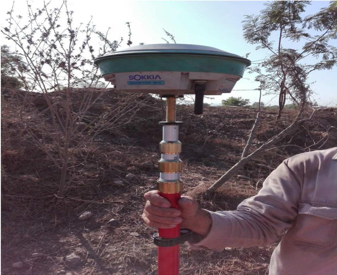
Instrumento utilizado para el levantamiento topográfico.
