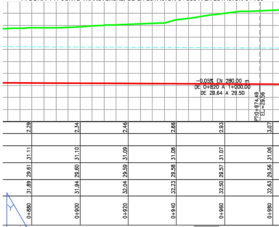
FIGURA 12. CORTE TRANSVERSAL, DE LA ESTACIÓN 0+980 A LA ESTACIÓN 1+100
