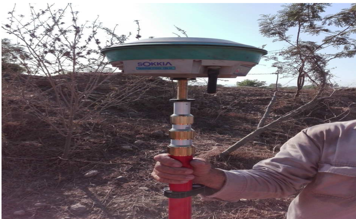
Imagen 33. Instrumento utilizado para el levantamiento topográfico.
