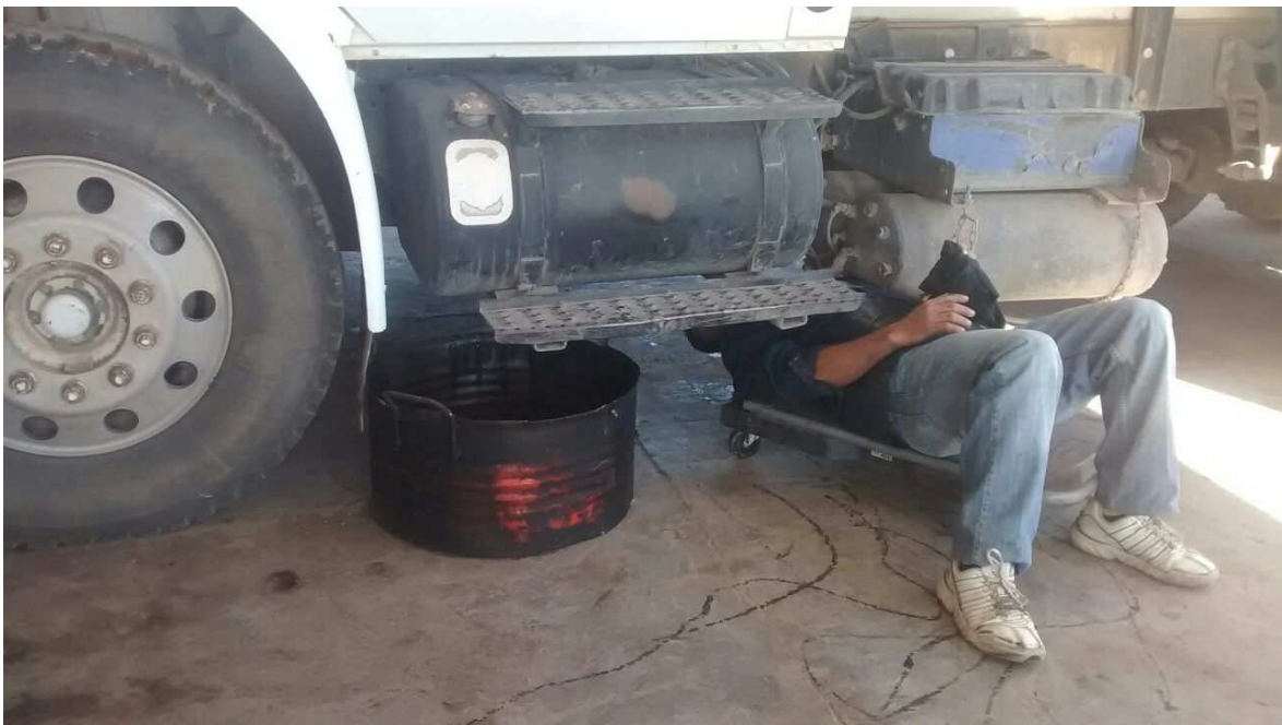
Imagen 9. Charola metálica para evitar derrames.
