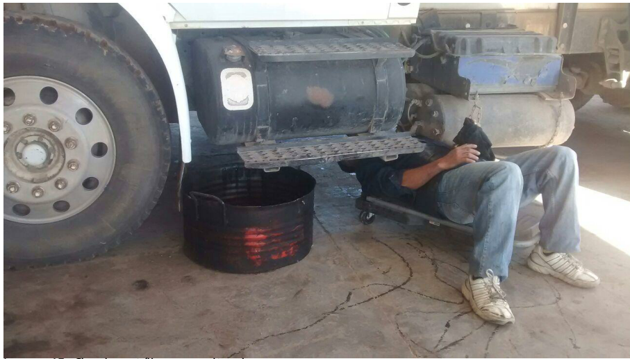
Imagen 15. Charola metálica para evitar derrames.
