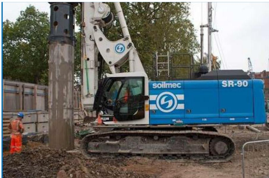
Figura II.24.- Perforadora rotativa
