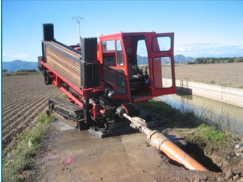
Figura V.1.- Perforadora dirigida, fotografía ilustrativa
