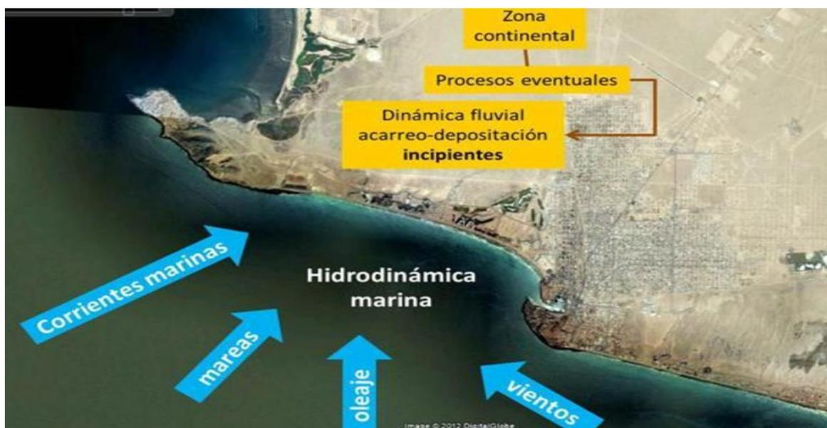
**Figura 8.** Principales procesos de hidrodinámica marina y geohidrología costera que determinan la zona litoral del Sistema Ambiental.
