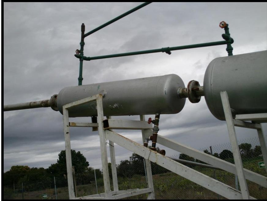
Foto 8. Los vapores saldrán del primer condensador y entrarán a un segundo condensador.
