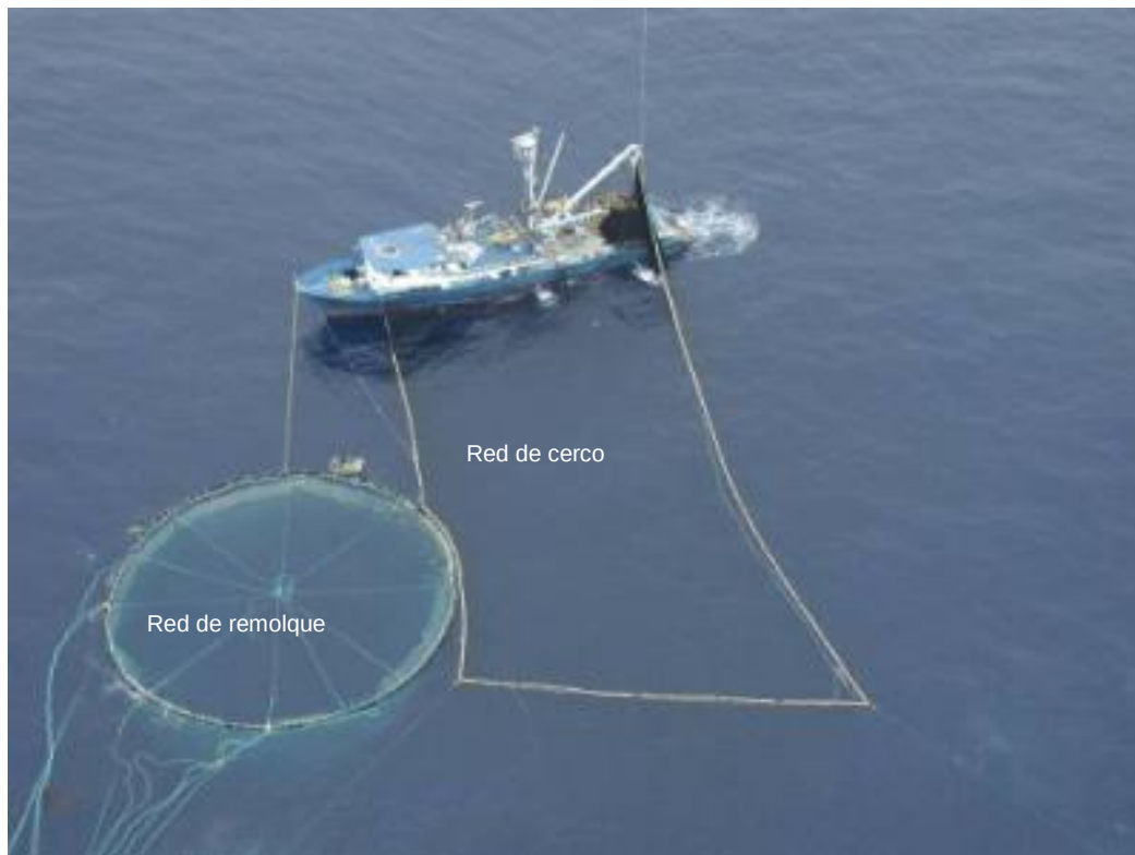
Foto 6. Otra vista de la red de cerco de un barco pesquero y la jaula y red de remolque. Servax Bleu, S, de R.L. de C. V.
