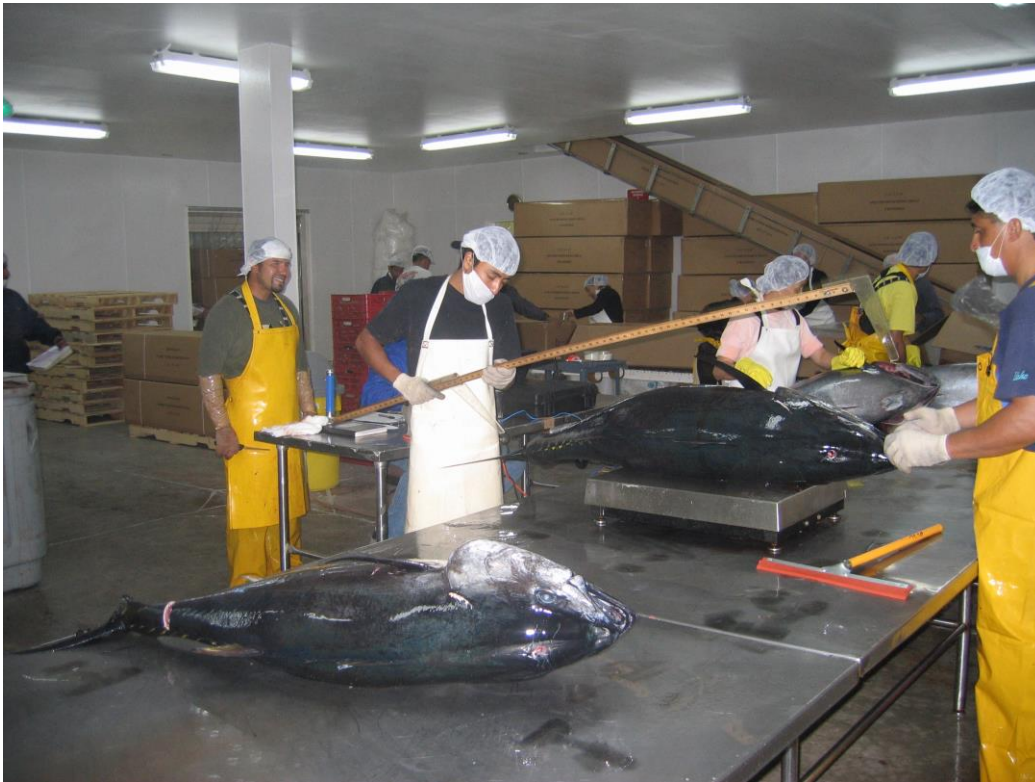
Foto 14. Planta maquiladora. Los organismos son medidos y pesados, después de ser limpiados y secados para su posterior empaque. Servax Bleu, S. de R.L. de C.V
