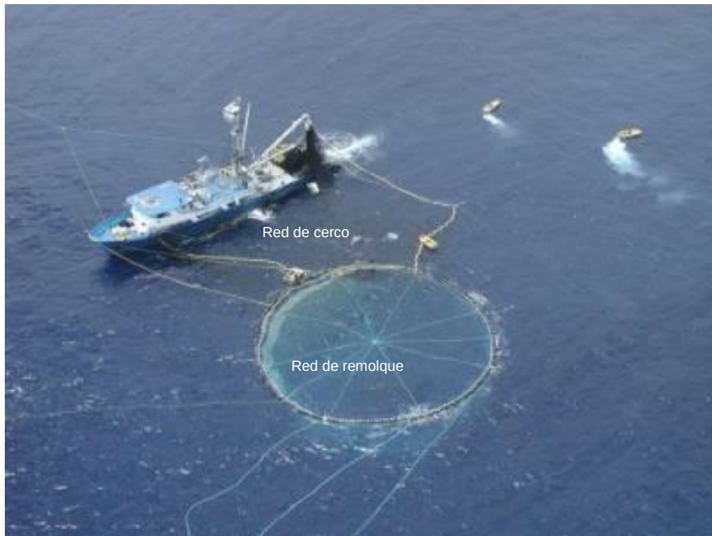
Foto 5. Vista del traspaso de atún aleta azul de un barco pesquero de red de cerco, a una jaula y red de remolque. Servax Bleu, S, de R.L. de C.V
