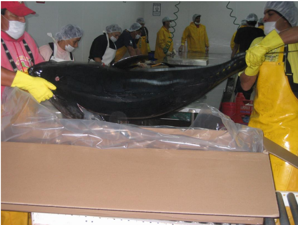
Foto 16. Planta maquiladora. Organismos empacados individualmente en cajas de cartón con bolsas de plástico y blue ice en su interior. Servax Bleu, S. de R.L. de C.V.
