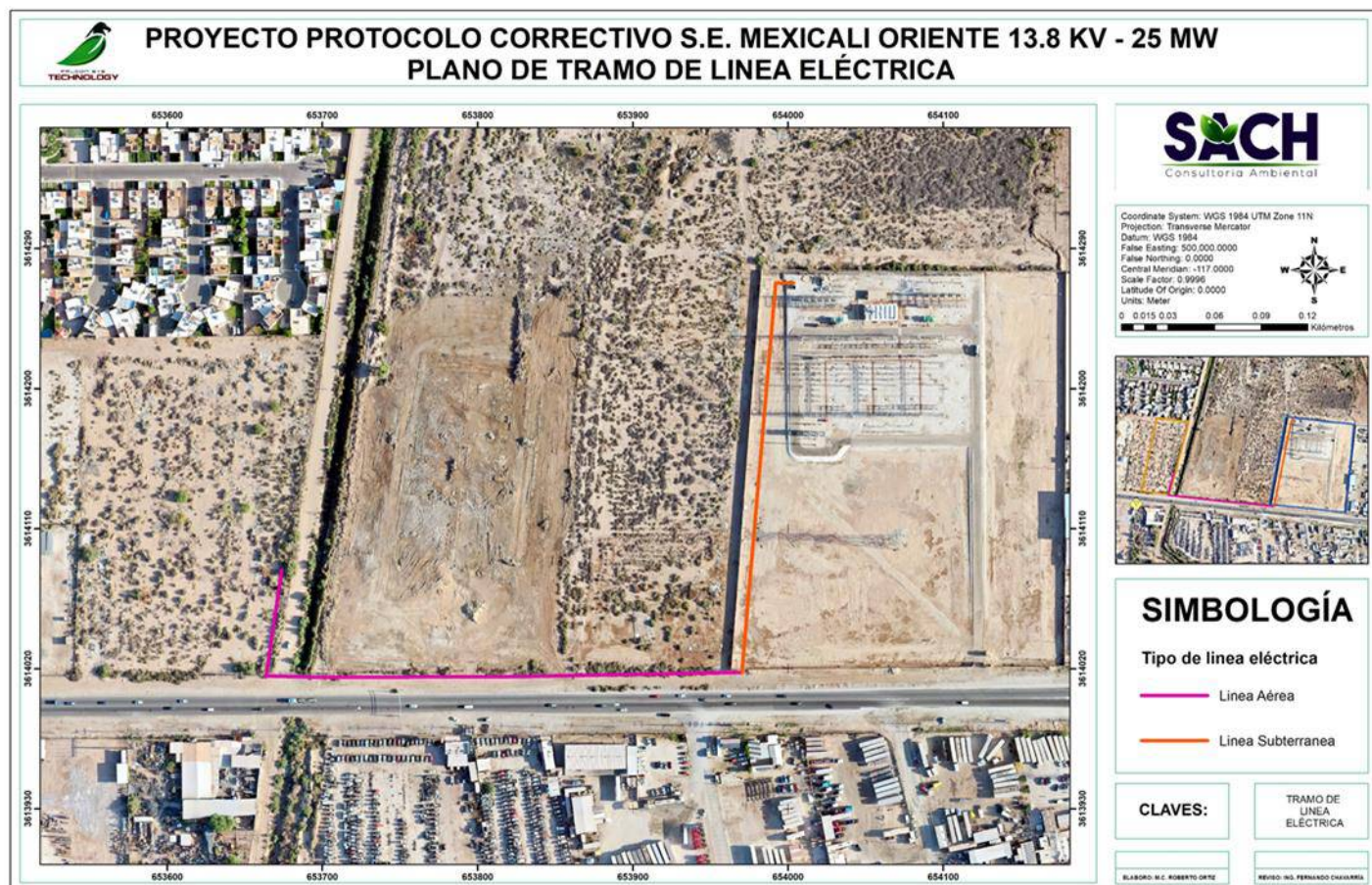
Ilustración 15 Plano de tramo de línea eléctrica
