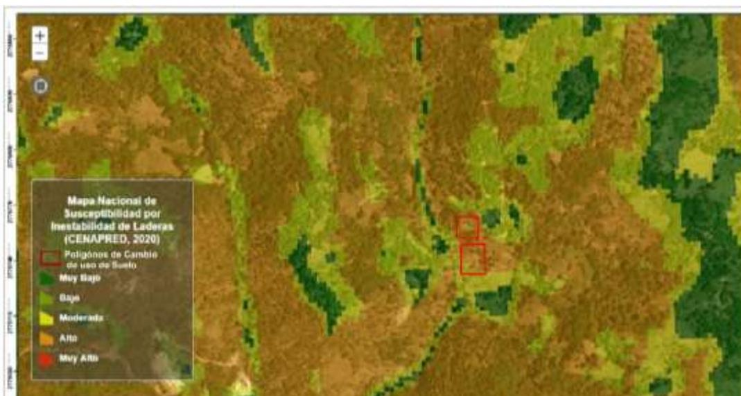
Figura IV-11. Clasificación de riesgo de deslizamiento de laderas
