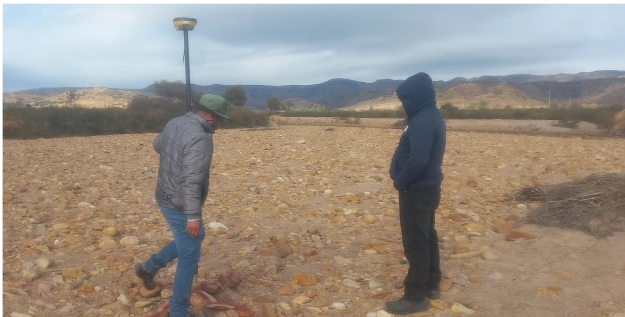
Ilustración 17. - Puntos de control auxiliares del área del proyecto para georreferenciar la ortofoto tomada con el dron
