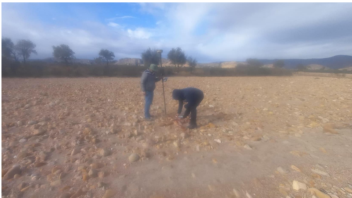
Ilustración 16.- Puntos de control auxiliares del área del proyecto para georreferenciar la ortofoto tomada con el dron
