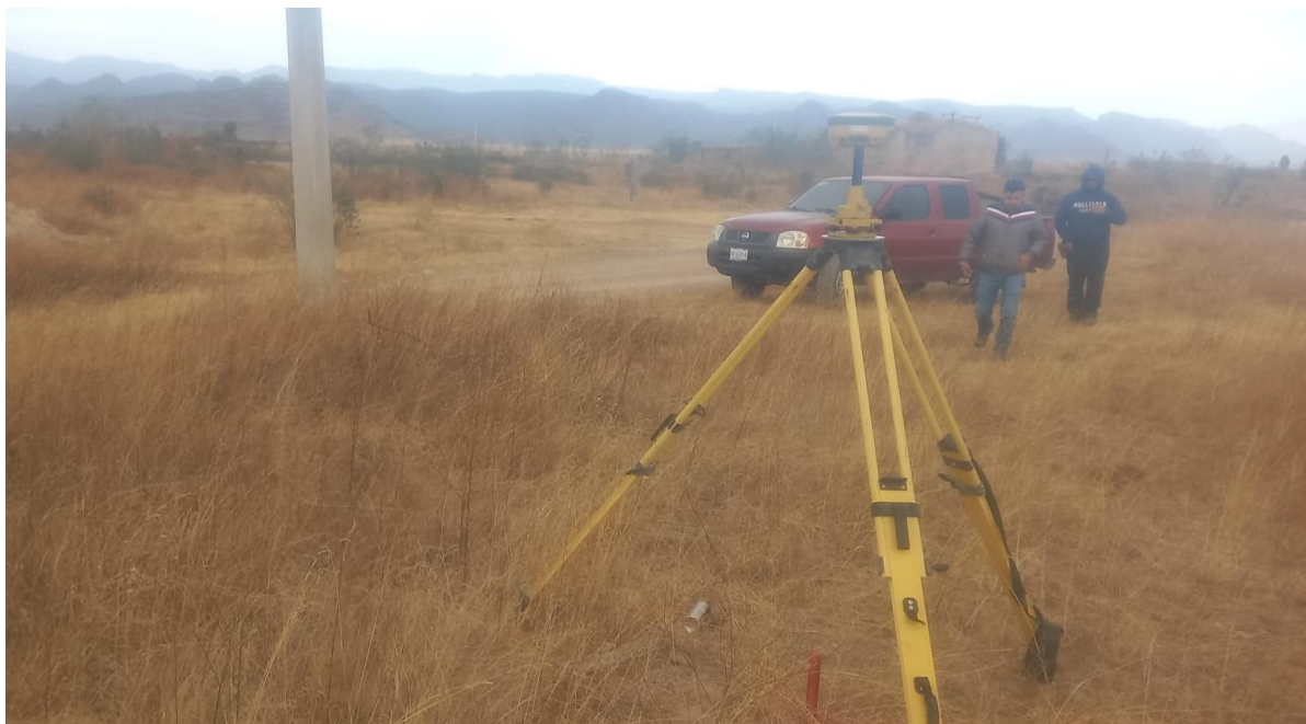
Ilustración 15.- Georreferenció de los bancos de material en campo (estableciendo el punto de control)
