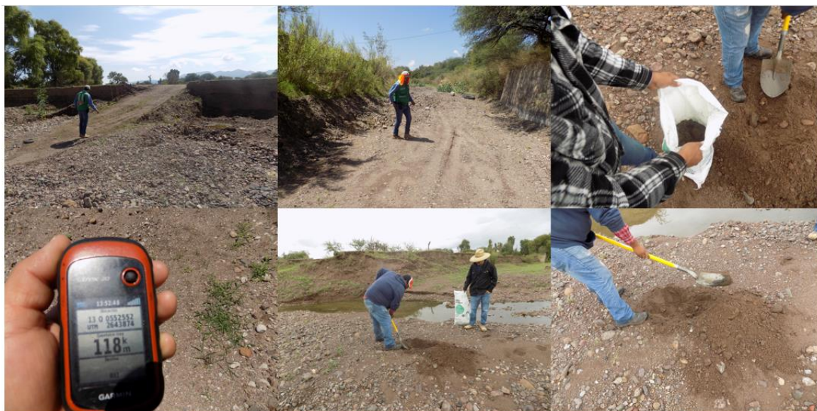
Figura IV-21. Excavaciones en el sitio para verificar profundidad y disponibilidad de material
