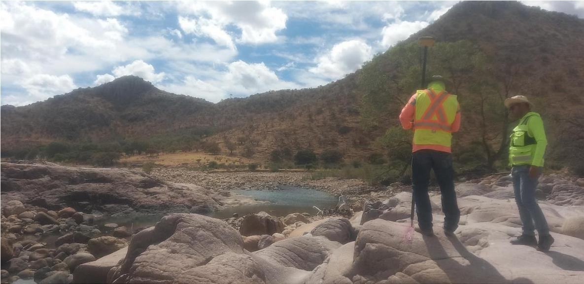
Ilustración 15.- Puntos de control auxiliares del área del proyecto para georreferenciar la ortofoto tomada con el dron
