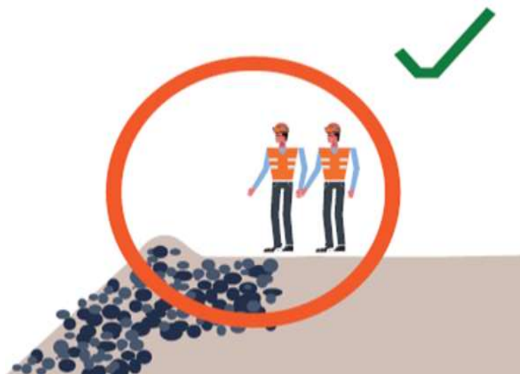
Figura II-19. Inspección del piso cercano al borde de los depósitos superficiales de tepetates.
