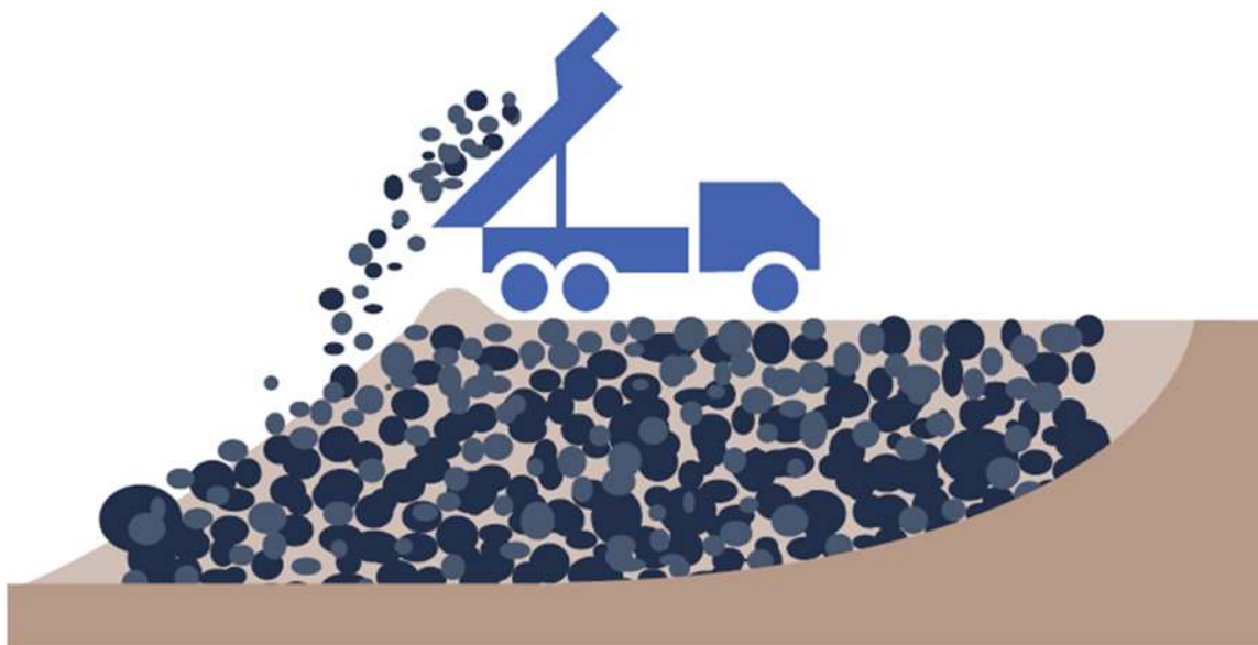
Figura II-18. Ejemplo de la operación de descarga en los depósitos superficiales de tepetate.
