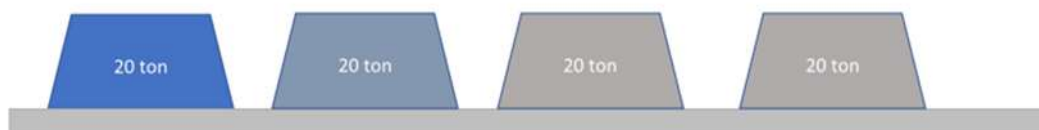
Figura II-14. Acopio de mineral a granel en pilas en forma de cono truncado de 20 tons c/u
