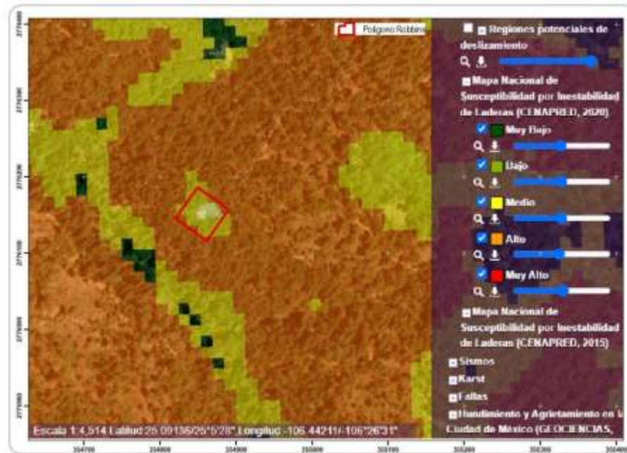
Figura IV-13. Clasificación de riesgo de deslizamiento de laderas
