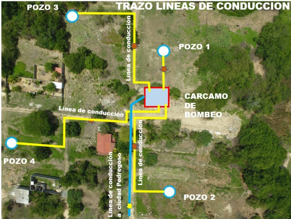
Fig. 8.- Dentro del levantamiento topográfico de la línea de conducción se identificaron y levantaron los cruces de líneas entre los pozos, con el mismo procedimiento y equipo de estación total .
