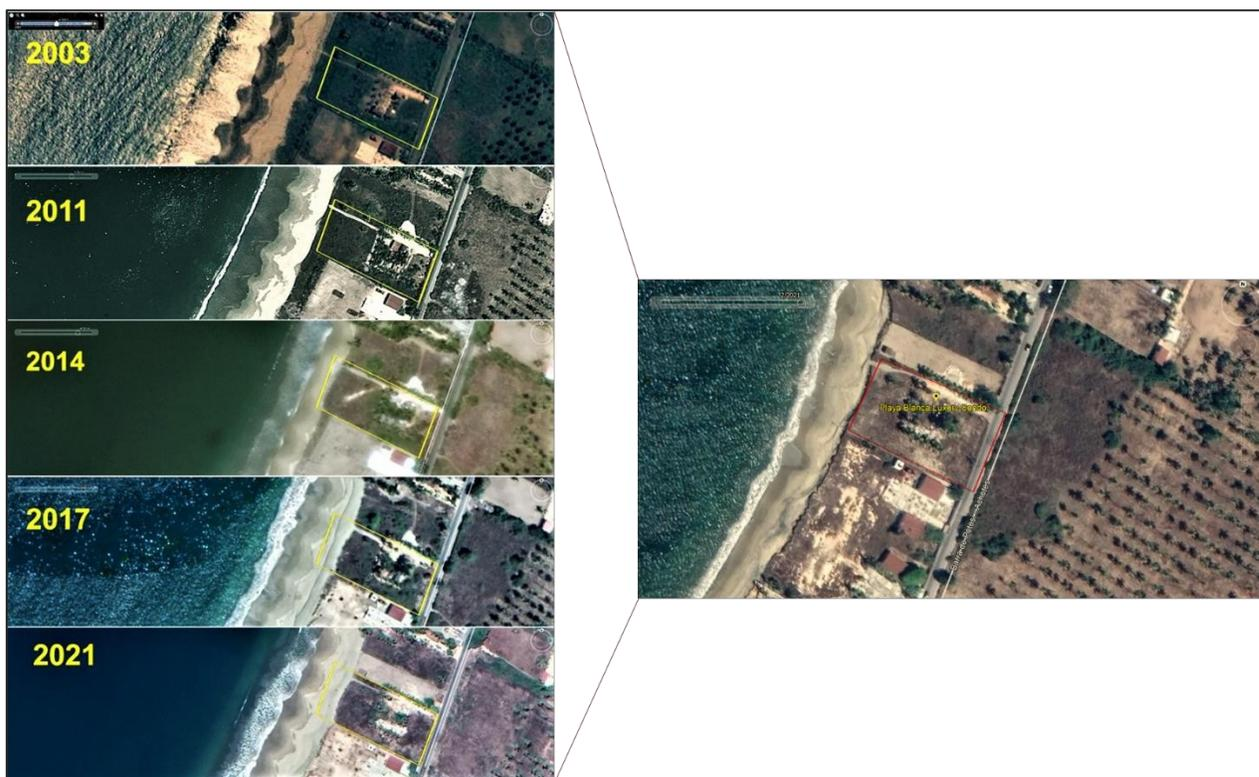
Imagen 05. Muestra el grado de erosión progresiva que con el transcurso de los años de 2003-2021 ha perdido el sitio debido al socavado propio de eventos naturales extraordinarios; específicamente, el alto oleaje que generan las marejadas, huracanes y ciclones.
