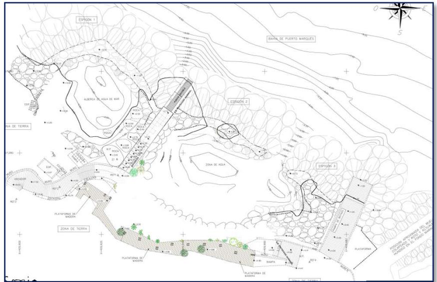
Dichas construcciones no serán de elevaciones considerables, sólo estarán a un máximo de 3m en sus puntos más altos que sería un puente que daría la salida de la dársena 2 a usuarios de kayak o nadadores y para conectar con el nivel superior existente en una rampa; en lo general, solo tendrá un nivel de 1.50m S.N.M. para integrarse a su entorno.
