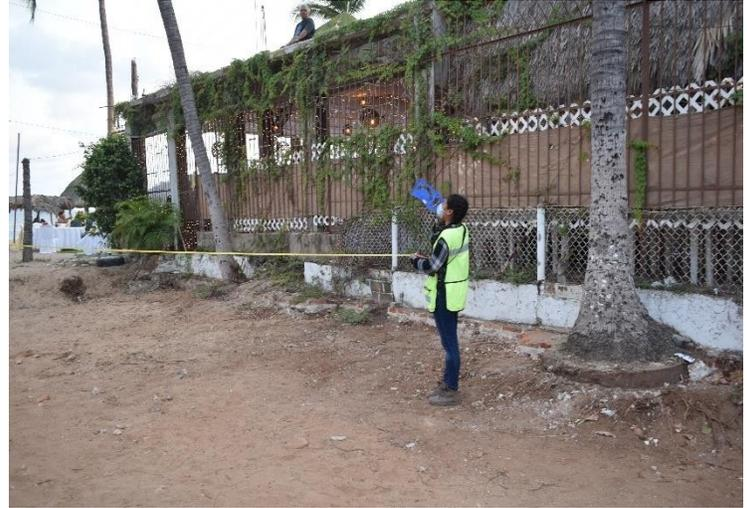
**Fotografía.** Alusiva a la toma de altura con el Clinómetro portátil.
