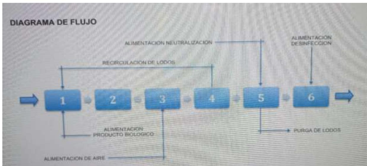
Imagen 18. Diagrama de flujo de la planta de tratamiento
