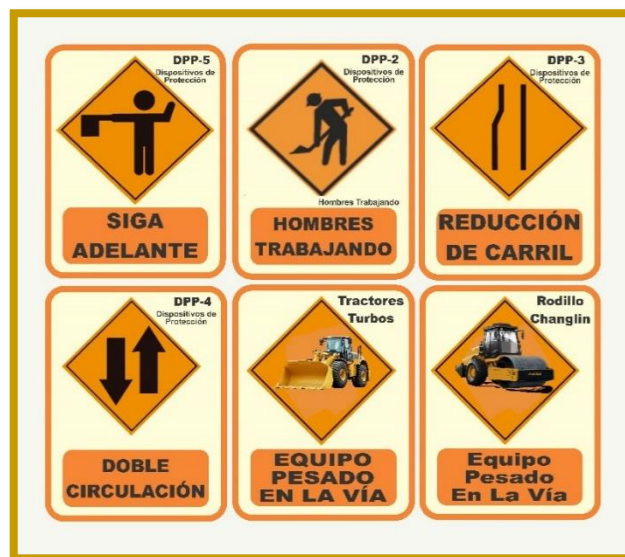
Figura II.2.11.1. Señalizaciones de hombres trabajando.
