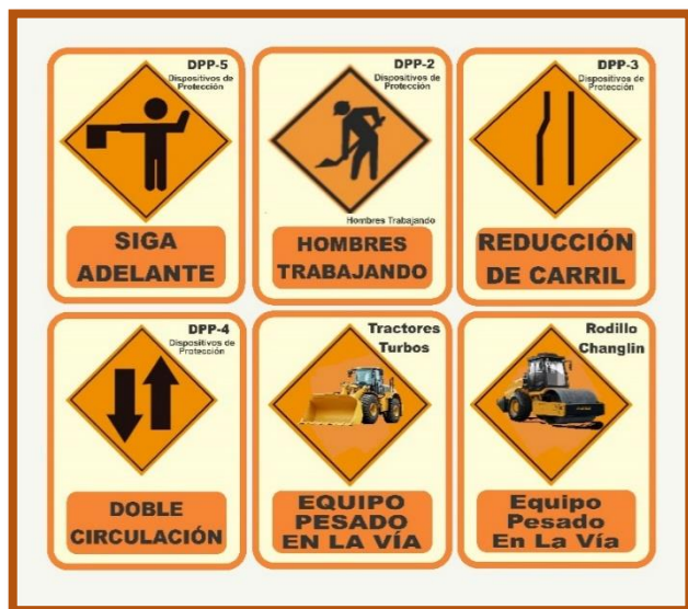
Figura II.2.11.1. Señalizaciones de hombres trabajando.
