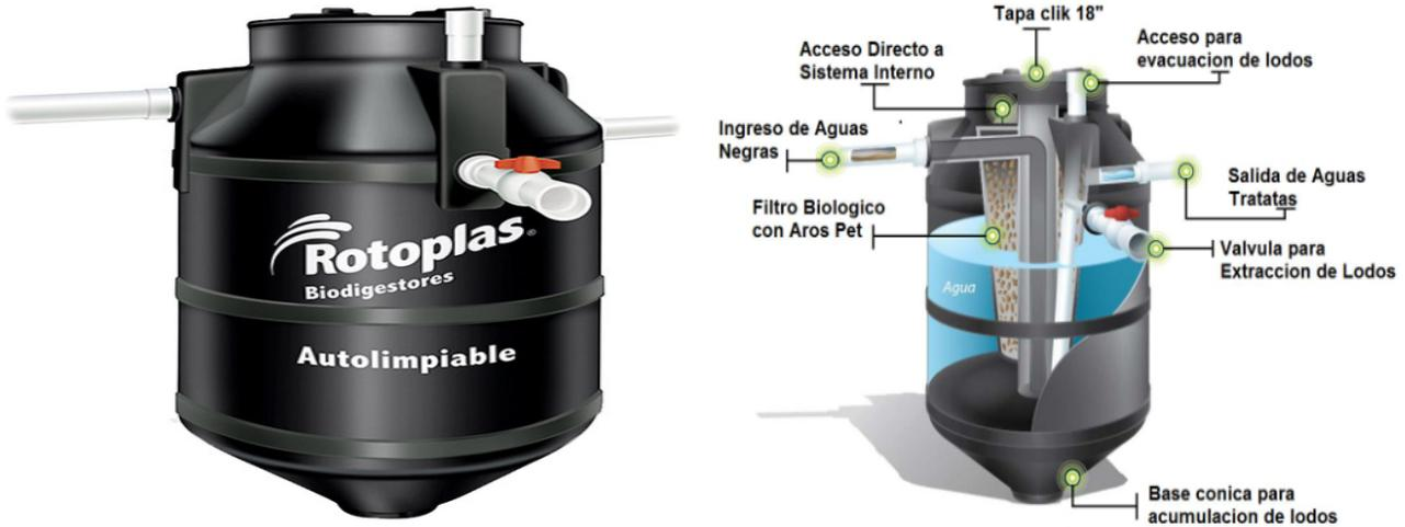
**Figura 9.** Partes del Biodigestor autolimpiable. Fuente: ROTOPLAS.
