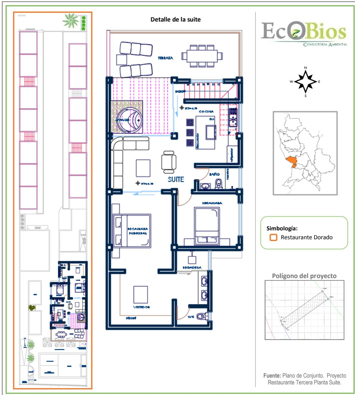
**Figura II.12** Detalle del diagrama del polígono de la tercera planta (Suite)
