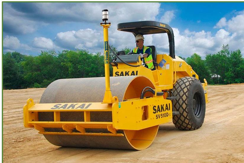
Ilustración II-29 Compactador vibratorio de rodillo liso.
