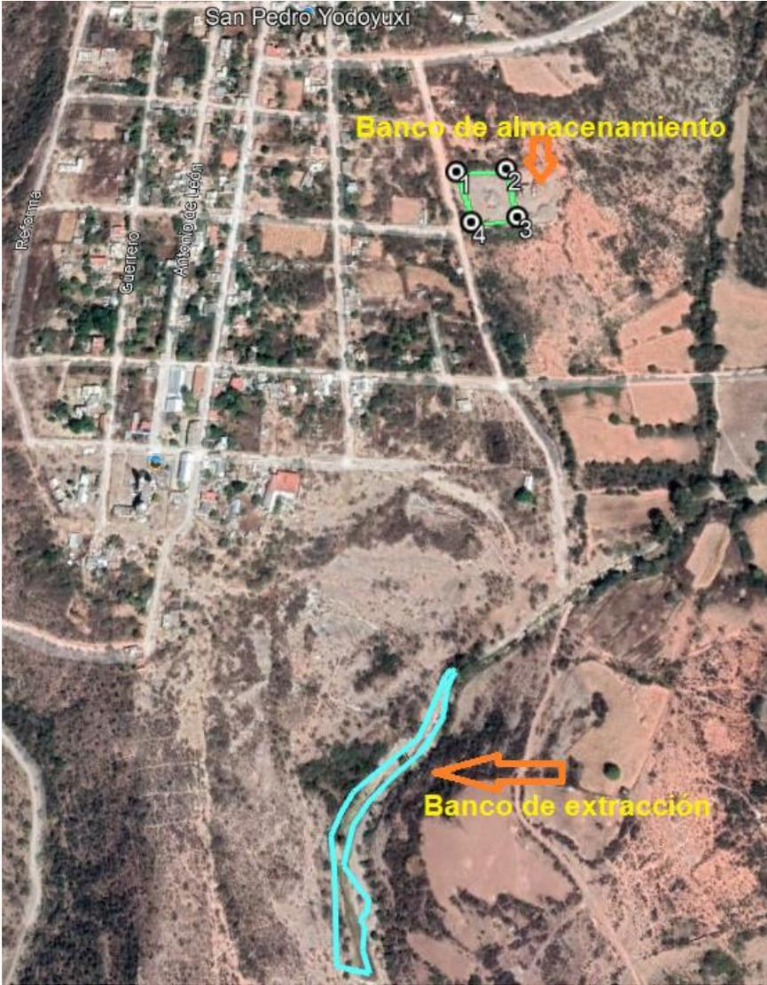
Ilustración II-6 localización del área de almacenamiento donde se instalara una criba para seleccionar el material en diferentes medidas.
