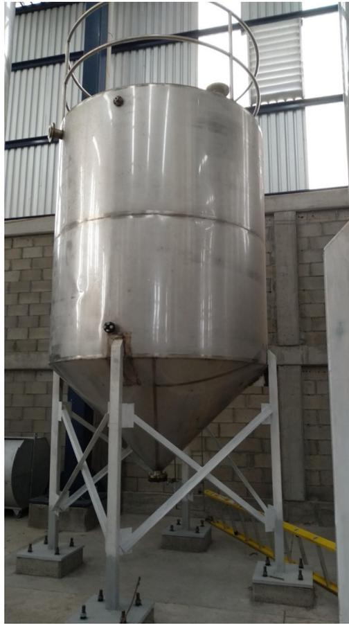
**Figura 22.** Tanque deodorizador
