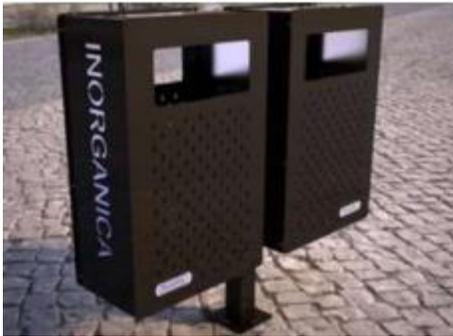
Contenedor de basura con estructura tubular rectangular de  $\frac{3}{4}$  calibre 16. Poste central mediante un tubular cuadrado de 3" cal 14. La cubierta de las charolas es mediante lámina calibre 18 con dobleces estructurales.
