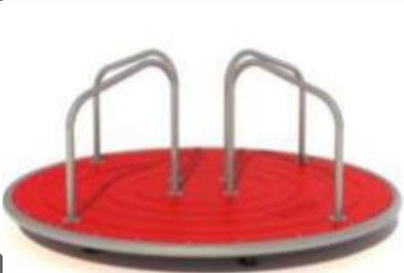
Volantín de estructura principal conformada por una plataforma circular fabricada en tubo de 2" cal 14 de 1800 mm de diámetro rodada en maquinaria CNC, cuenta con una estructura central de refuerzo en tubular de 1 ½ cal 14, con refuerzo central para el eje de giro en placa 3/16 cortada en laser CNC. Buje central de 100 mm que alberga el sistema de rotación. La plataforma está forrada en plástico HDPE de  $\frac{3}{4}$ " con grabado antiderrapante maquinado en
