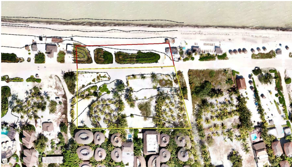
Figura 55. Curvas de nivel de la Zona Federal Marítimo Terrestre y los Terrenos Ganados al Mar donde se pretenden realizar las actividades recreativas, obtenidas mediante el método kringing, con ayuda del software especializado Arcmap 10.0.
