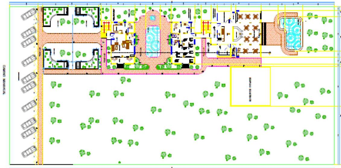
Las siguientes imágenes (9 y 10) presentan el perfil de alturas del proyecto, en ésta se puede apreciar que la altura máxima del conjunto será de 8.80 m a partir de 1 metro sobre el nivel del piso, con cimentación a base de pilotes sembrados a una profundidad de 1.2 m. cada planta tendrá 2.60 m de altura con entrepisos de 20 cm. La alberca tendrá una profundidad máxima de 1.50 m.
