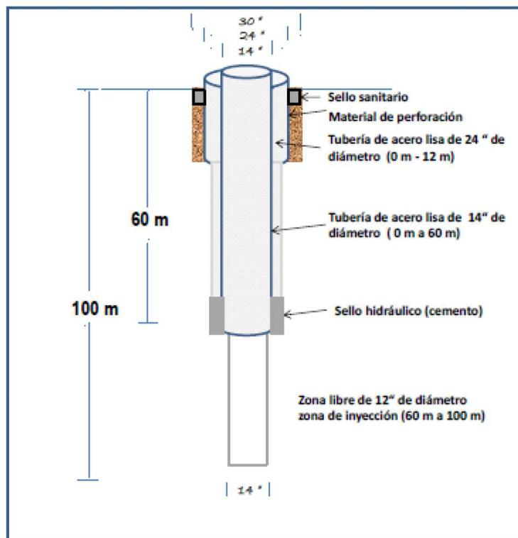
**Imagen 18.-**Diseño final de pozo de inyección de agua de rechazo.
