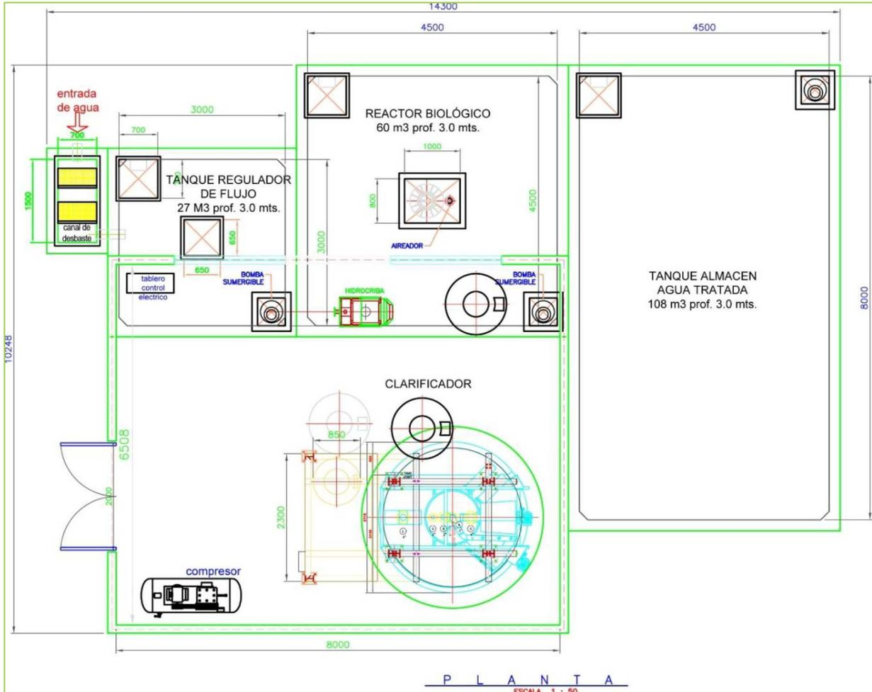
**Imagen 16.** Se muestra la distribución de los componentes de la planta de tratamiento. Nota: las cotas de dimensiones se expresan en milímetros (mm). Propiedad de BIODAF.
