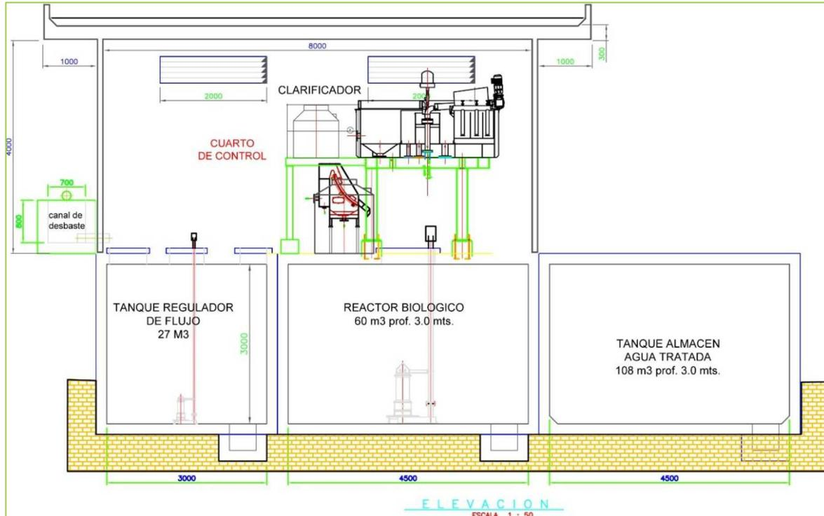
**Imagen 17.**-Se presenta un corte esquemático con los tanques, el reactor biológico y el clarificador de la planta. Propiedad de BIODAF
