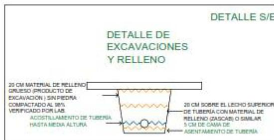
**Figura 8a.** Detalle del sistema de Aguas Residuales, antes de ser interconectada a la Red de la CAPA.
