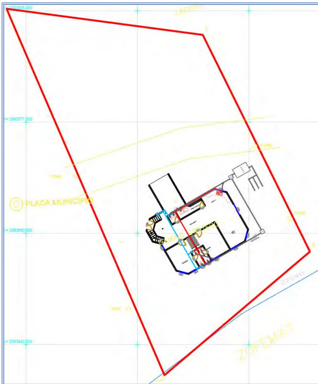
En esta imagen del plano de conjunto se aprecia la distribución de todas las obras de la vivienda en Planta Baja, misma que contará con un solo módulo de vivienda principal con área de estacionamiento adosado, registros sanitarios, micro Planta de Tratamiento, y campo de oxidación, todo sobre un área de **157.6718 m<sup>2</sup>**.
